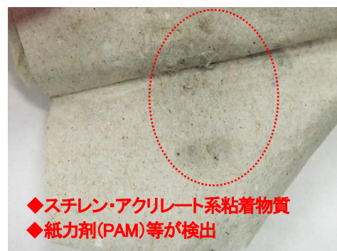
図10 抄き込み欠陥の状態
